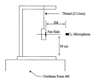
1 METER FROM MICROPHONE TO FAN INTAKE
