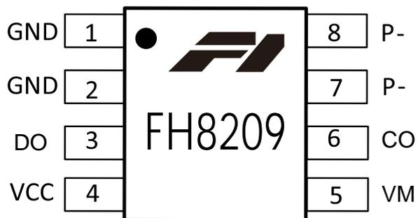
图 1 FH8209 管脚排列图（不成比例）
