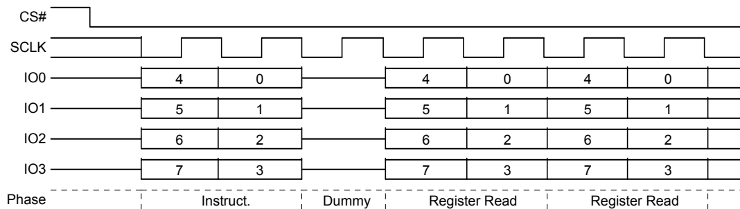
图 112. 保护寄存器读取（PRRD）命令序列 — QPI 模式
