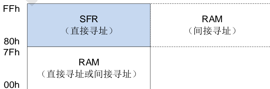
内部 256 bytes RAM 结构图
