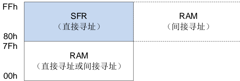
内部 256 bytes RAM 结构图
