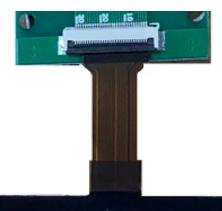
HS19264G06A 又昇 SIZE:107.5\*47.1\*6.1 VA:104\*39 AA:97.5\*32.5 IIC DOTS:192\*64 IC:ST7525 4SPI WX:13418624768 IN8080/6800
