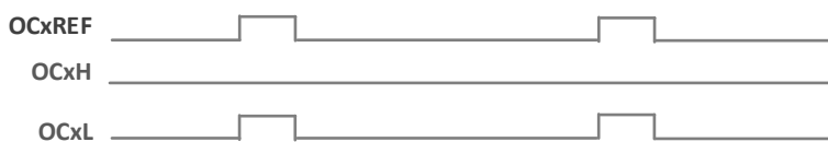
图 15-6 死区时间大于正电平
