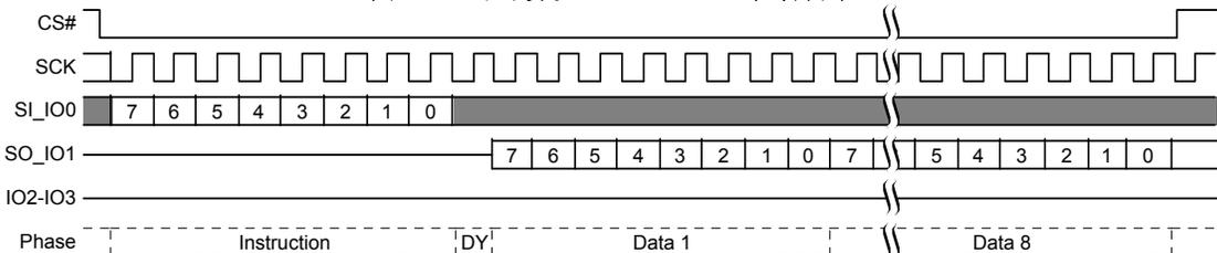
在 QPI 模式下, 器件也支持该命令。在 QPI 模式下, 通过 IO0-IO3 信号将指令传入到芯片内, 同时传出返回的数据。
