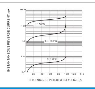
Fig.4-TYPICAL REVERSE CHARACTERISTIC
