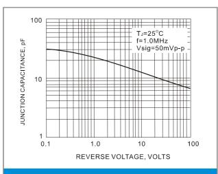
Fig. 2 TYPICAL JUNCTION CAPACITANCE
