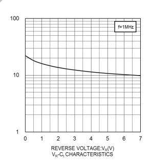
CAPACITANCE BETWEEN TERMINALS:C<sub>t</sub>(pF)
