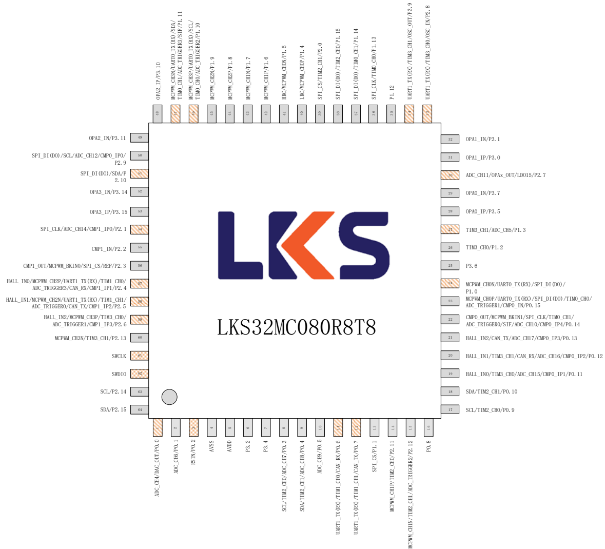
图 3-1 LKS32MC080R8T8 管脚分布图
