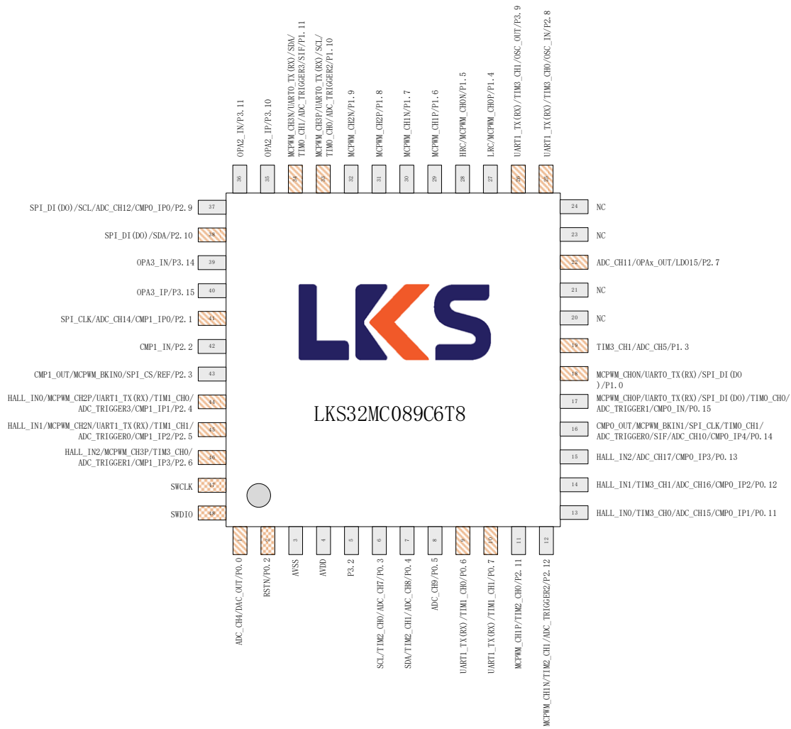
图 3-9 LKS32MC089C6T8 管脚分布图
