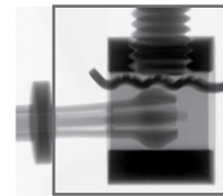
举例：搭接使用 T-785 M 在 PCB 端子中
