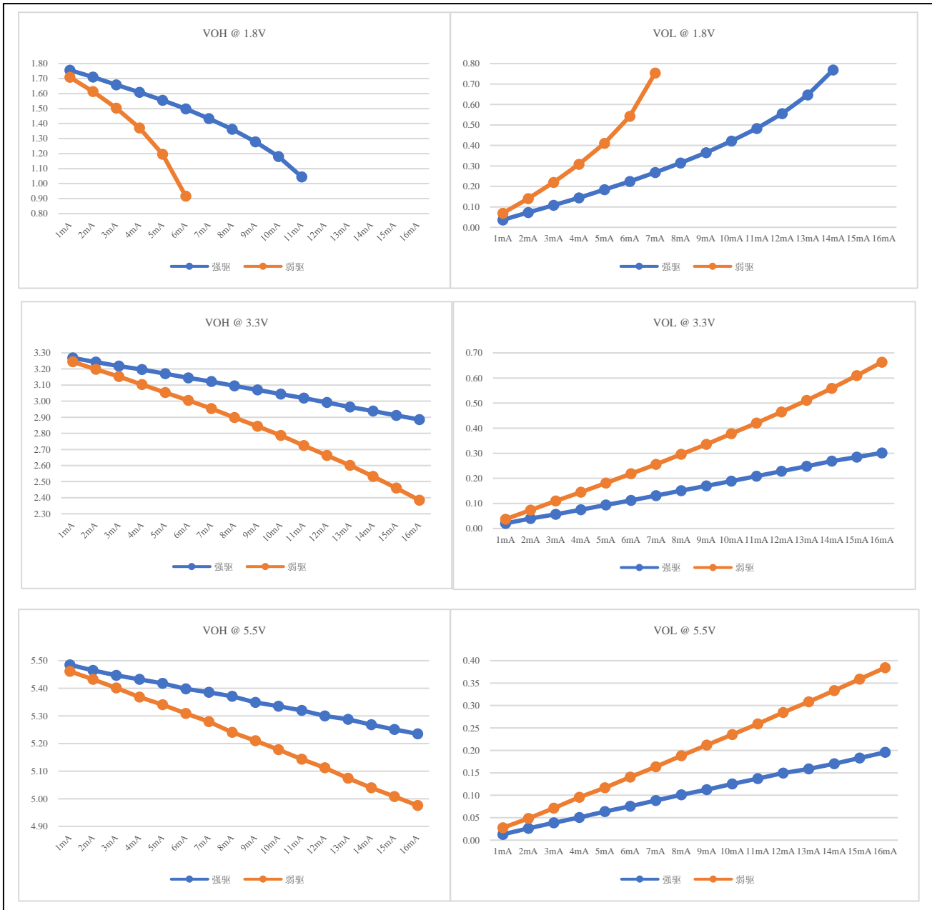
图 7-2 输出端口 VOH/VOL 实测曲线
