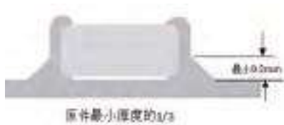
A.回流焊接的最佳焊料用量
