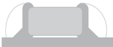
A.焊料过多这样会因电容端头压力过大而引起电容受损；
