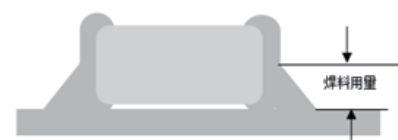
C.使用烙铁返修时的最佳焊料量
