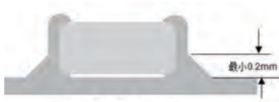
A.回流焊接的最佳焊料用量
