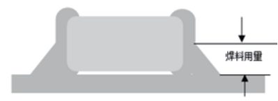
C.使用烙铁返修时的最佳焊料量
