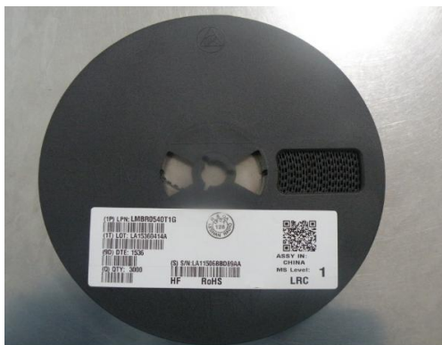
7英寸卷盘标签张贴及QA印章位置
