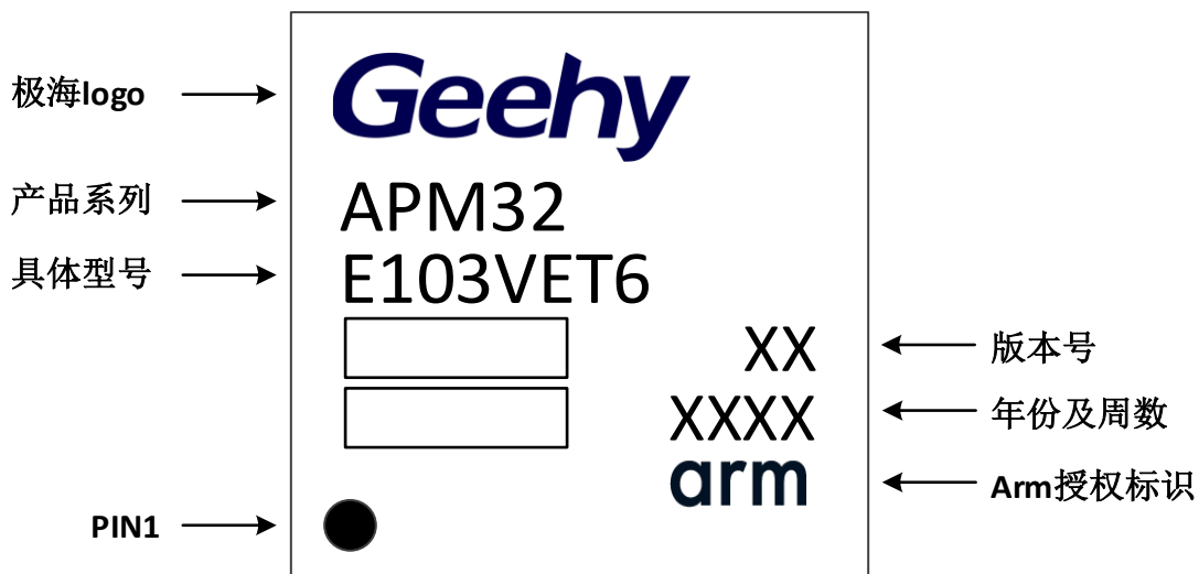
图 23 LQFP100 - 100 引脚，14 x 14mm 封装标识
