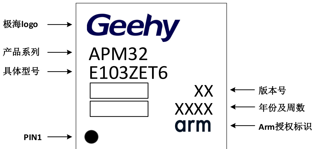
图 20 LQFP144 -144 引脚，20 x20 mm 标识图
