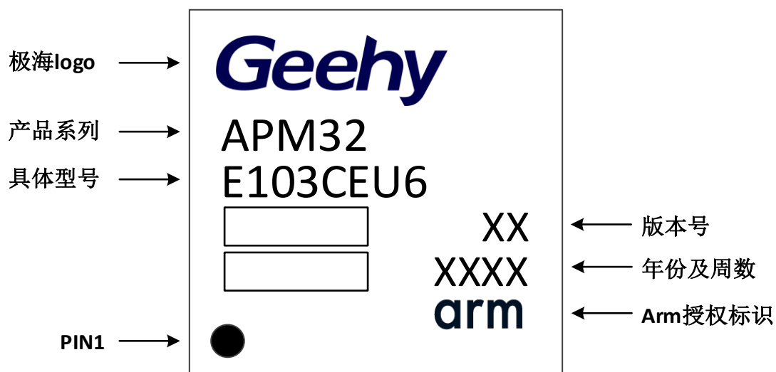
图 32 QFN48-48 引脚 7×7mm 标识图
