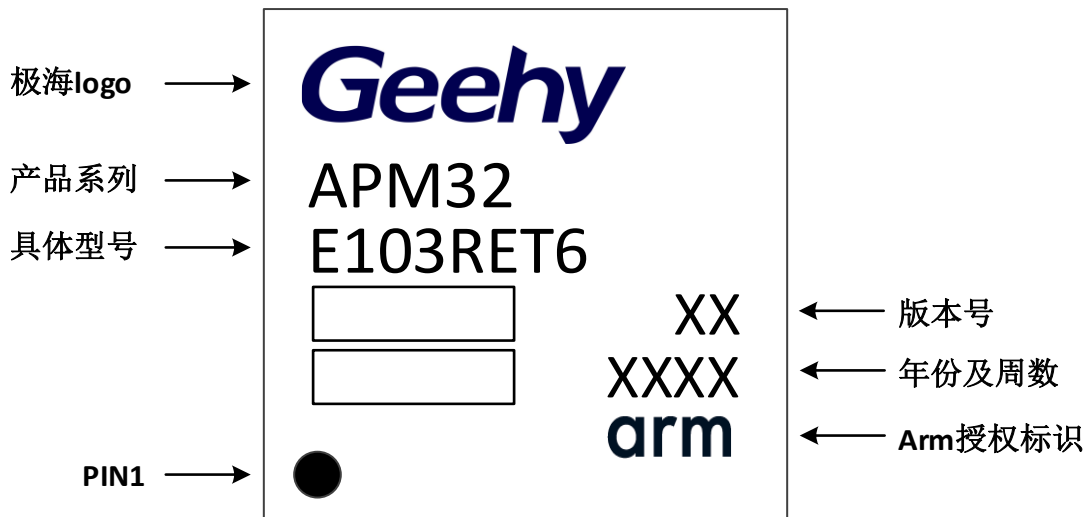
图 26 LQFP64 - 64 引脚，10 x 10mm 封装标识
