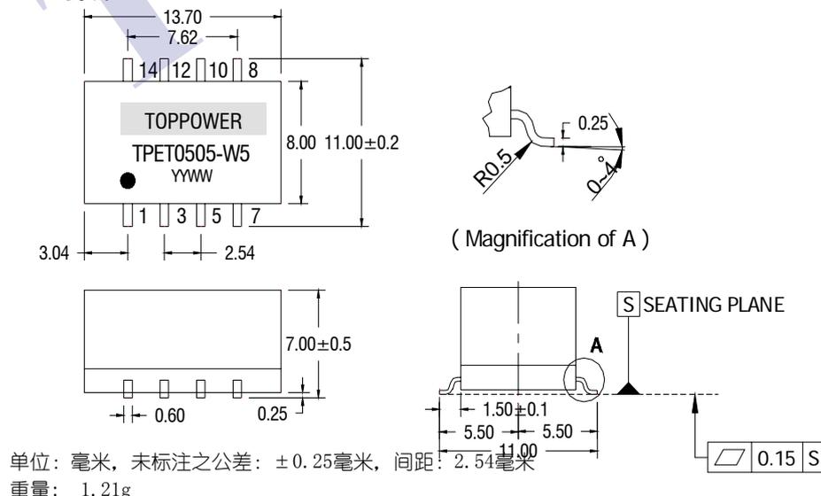
单位: 毫米, 未标注之公差: ±0.25毫米, 间距: 2.54毫米
