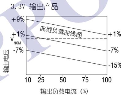
输出电压精度曲线图
