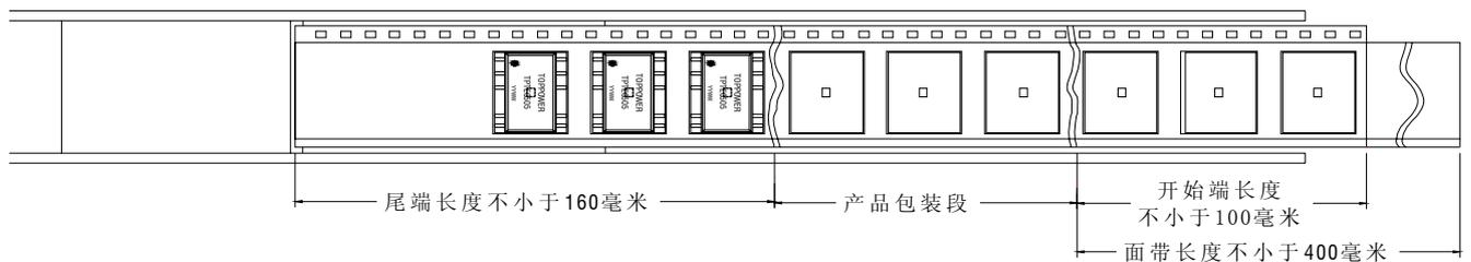
产品方向：端子1位于最靠近载体驱动链轮处
