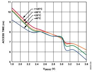
Figure 12. Access Time vs. VDRIVE
