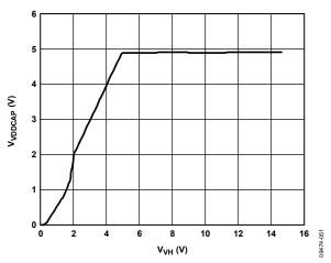
Figure 5. V<sub>VDDCAP</sub> vs. V<sub>VH</sub>
