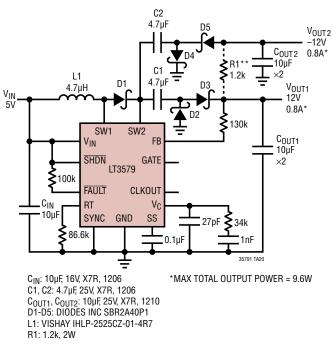
1MHz, 5V to ±12V Converter
