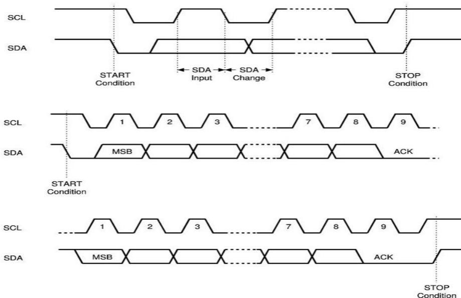
图 3 I<sup>2</sup>C 通信协议时序图
