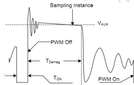
图 1 辅组绕组上电压波形曲线
