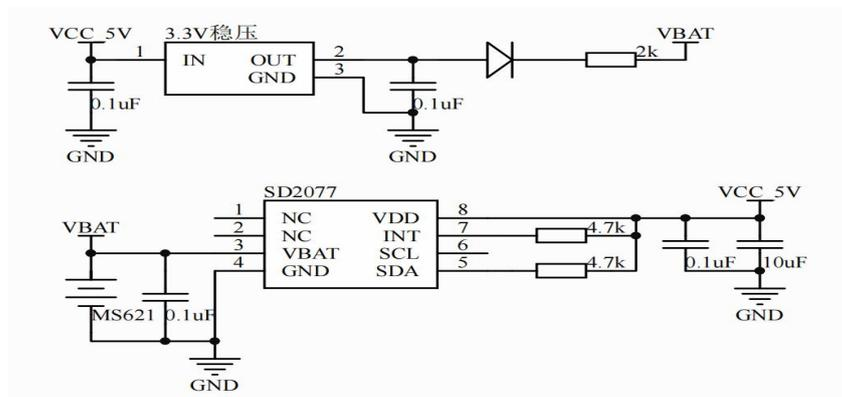
特别的：对长线传输、强干扰的 IIC 总线环境，可以考虑在靠近 SD2077 端的 SDA、SCL 线加上 RC 低通滤波电路（串联 100 欧电阻+对地 100PF~200PF 的电容）。
