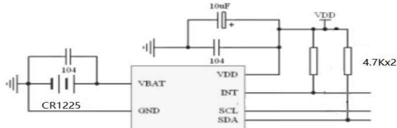
(2) 3V 充电电池 ( $V_{DD}=5.0V$ )
