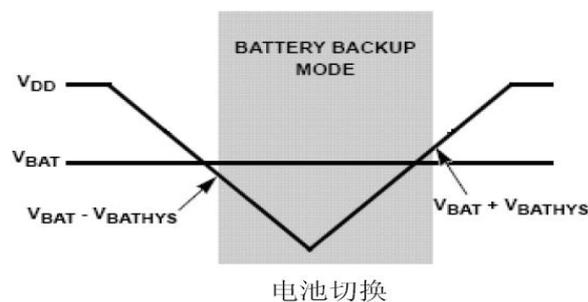
在后备电池供电模式中, IIC 总线通信功能持续允许, 实时时钟芯片的数据读写功能均可实现。
