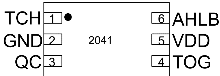
图 2 2041SOT23-6 管脚示意图
