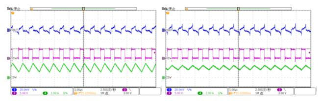
Ripple : VIN=5.0V, VO=1.8V, EN=3.6V IO=1A
