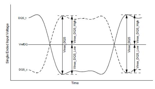
Figure - DQS Single-Ended Input Voltage
