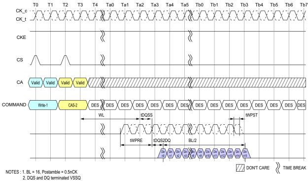
DQS\_t/DQS\_c is "don't care" prior to the start of tWPRE. No transition of DQS is implied, as DQS\_t/DQS\_c can be HIGH, LOW, or HI-Z prior to tWPRE.
