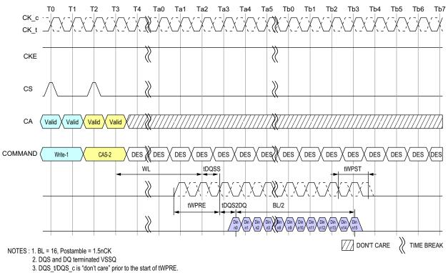
No transition of DQS is implied, as DQS\_t/DQS\_c can be HIGH, LOW, or HI-Z prior to tWPRE.
