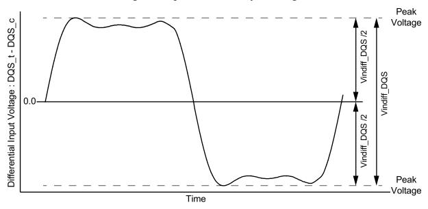
Figure - DQS Differential Input Voltage
