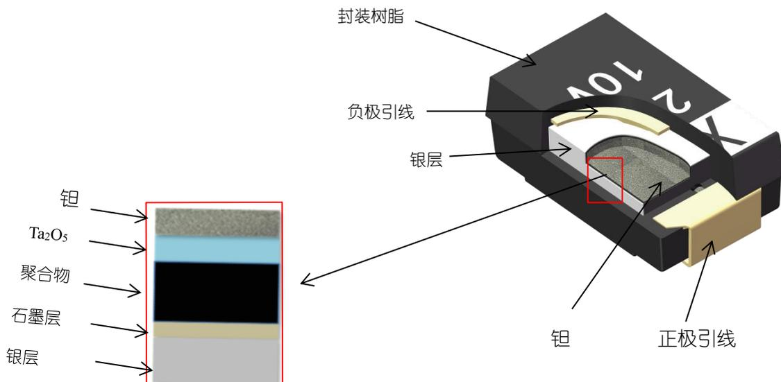
图 1. PX-Cap 剖面及局部放大图
