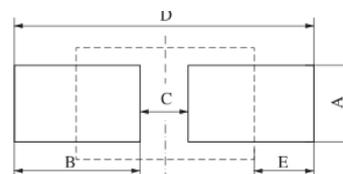
图 2（注：图中虚线为片式钽电容器的位置）
