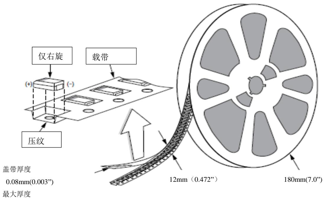
图 14. PY-Cap 卷盘及包装带示意图
