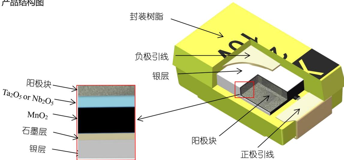
图 7. 产品结构图简介
