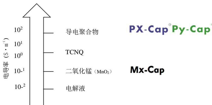
图 2. 典型电容器电解质电导率图
