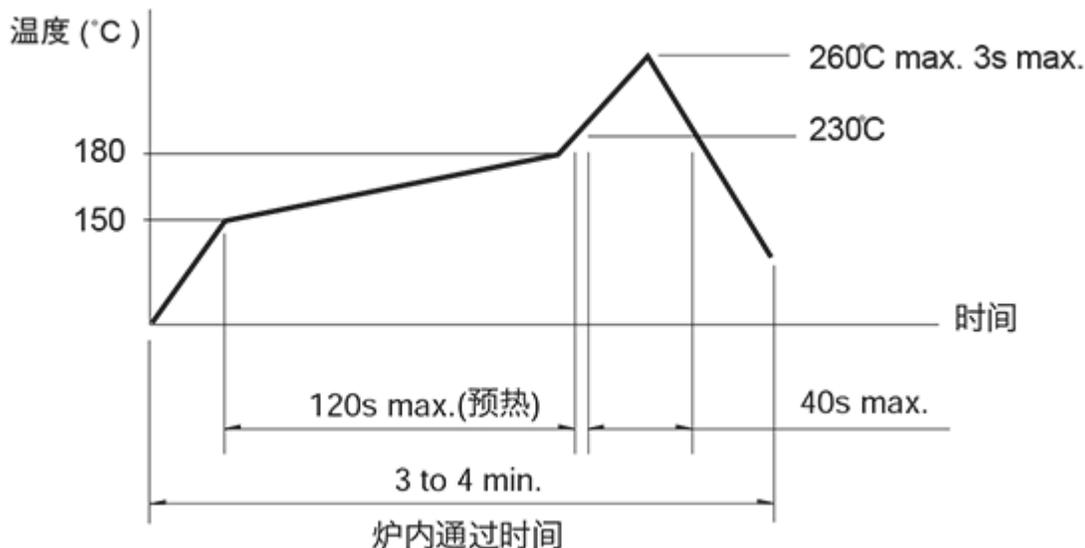
(1) 上述条件,为印刷电路板的零部件表面的温度。根据电路板的材质,大小,厚度等,电路板温度和开关表面温度会有很大的不同,关于开关表面温度,也请在上述条件内使用。
