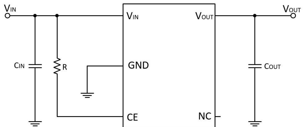
Note1:Input capacitor  $C_{IN}=1\mu F$ .
