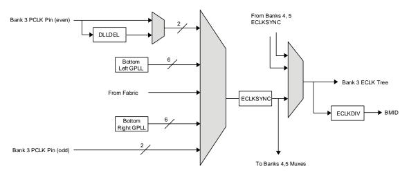
Figure 2.8. Edge Clock Sources per Bank
