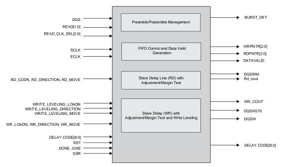
Figure 2.26. DQS Control and Delay Block (DQSBUF)
