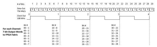
Figure 3.11. DDRX71 Video Timing Waveforms
