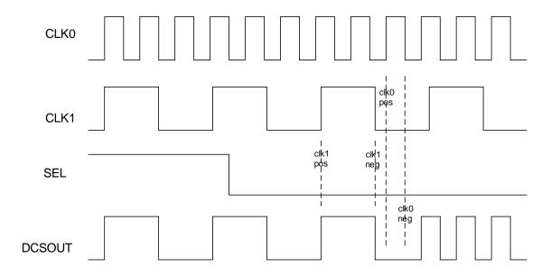
Figure 2.10. DCS Waveforms
