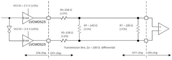
Figure 3.2. LVDS25E Output Termination Example
