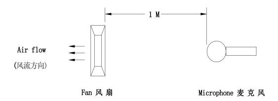
(在背景噪音不超过 18dB(A)的无响室内,将待测风扇通入额定的工作电压,悬掉入空中,将麦克风放于风扇
