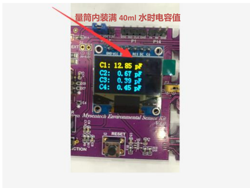
图 12 量筒中有 40mL 水时的电容值
