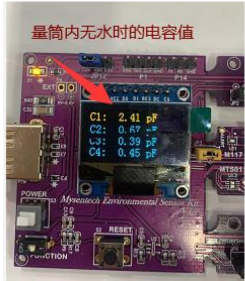
图 11 量筒中无水时的电容值
