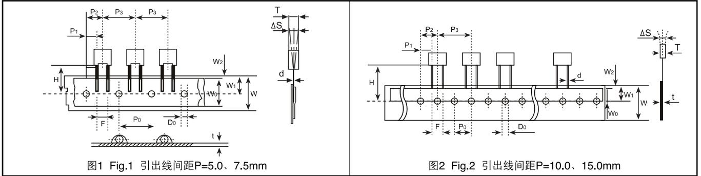
图1 Fig.1 引出线间距P=5.0、7.5mm
