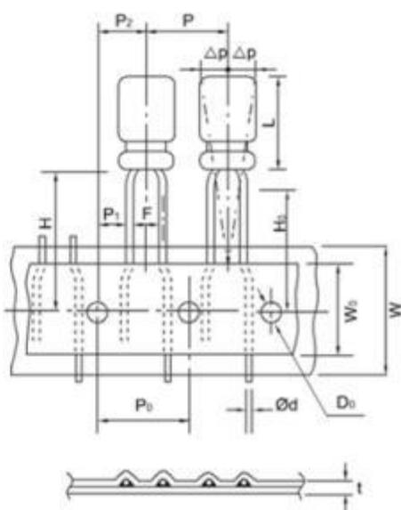
**■Lead Taping for Automatic Insertion 自動插件用引線編帶模式**
