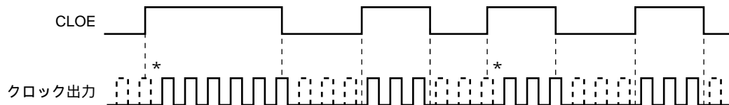
図12-6 リモコン出力応用例
