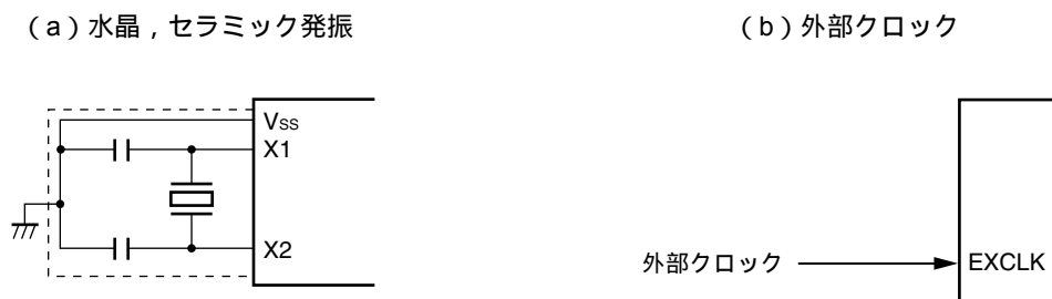
図6 - 12 X1発振回路の外付け回路例
