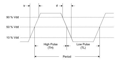
Figure 15. LVCMOS Waveform Diagram<sup>[13]</sup>
