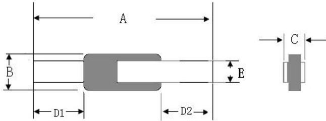
电极材料: 1/4 硬度纯镍片, 厚度为 0.10mm.
