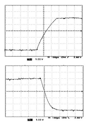
Figure 5. CRD\_VCC Typical Turn-on and Turn-off Times
