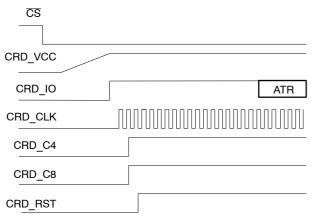
Figure 3. Startup CRD\_VCC Sequence
