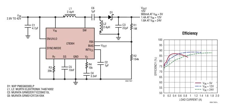
2MHz, 4.5V to 30V Input, 24V SEPIC Converter
