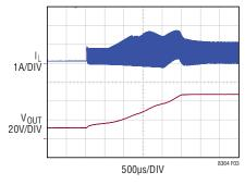
Figure 3. Soft-Start Waveforms
