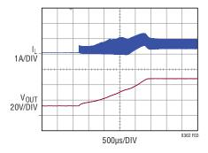
Figure 3. Soft-Start Waveforms
