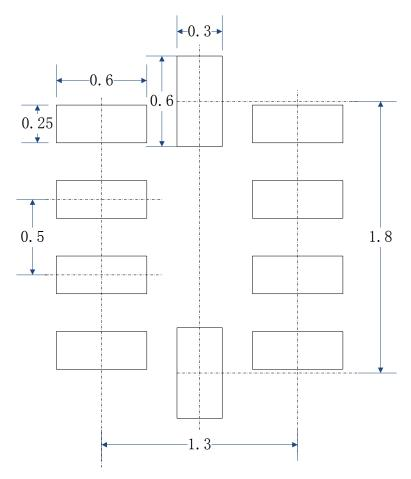
RECOMMENDED PCB LAYOUT PATTERN (Unit: mm)
