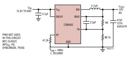
Figure 13. 12V, 8A Step-Down Converter
