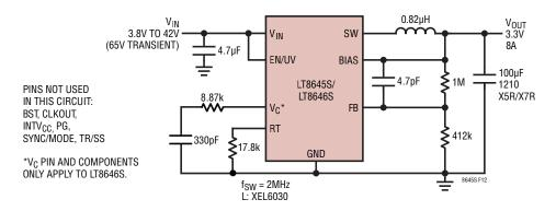
Figure 12. 2MHz 3.3V, 8A Step-Down Converter
