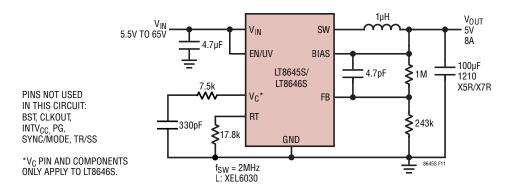
Figure 11. 2MHz 5V, 8A Step-Down Converter
