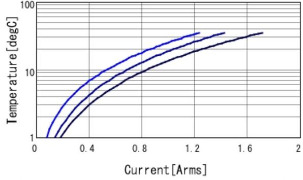
GRT155C8YA224KE01 Temp. rise ■ 300kHz ■ 600kHz ■ 1MHz
