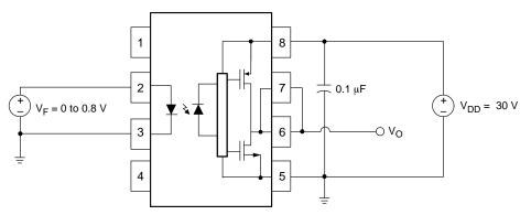
Figure 23. I<sub>DDL</sub> Test Circuit
