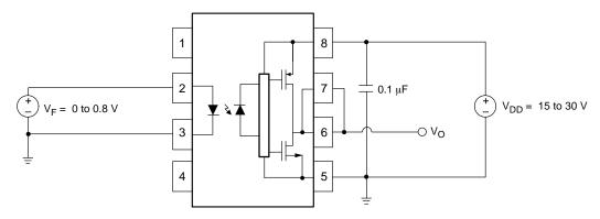
Figure 25. V<sub>FHL</sub> Test Circuit
