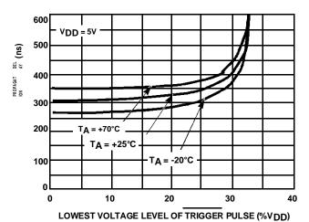
FIGURE 15. PROPAGATION DELAY vs VOLTAGE LEVEL OF TRIGGER PULSE
