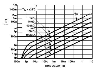
FIGURE 18. TIME DELAY IN THE MONOSTABLE MODE vs  $$\rm R_{\mbox{\scriptsize A}}$$  AND C
