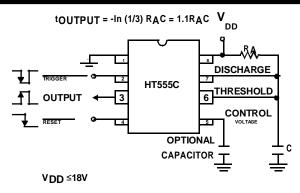
FIGURE 6. MONOSTABLE OPERATION
