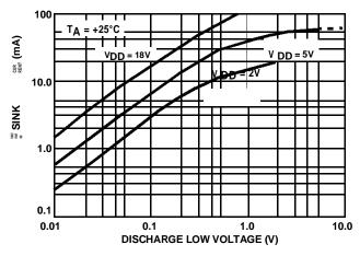
FIGURE 14. DISCHARGE OUTPUT CURRENT vs DISCHARGE OUTPUT VOLTAGE
