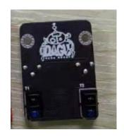
产品详情及参数:循迹模块是红外发射管发射光线到路面,红外光遇到黑色时则被吸收,接收管没有接收到反射光,输出高电平。当红外光遇到其他颜色时,接收管接收到反射光,输出低电平。该模块在使用模拟输出的时候,可以当作灰度传感器,灰度传感器是模拟传感器,可以感知地面或桌面不同的颜色而产生相应的信号。
