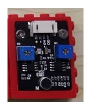
产品详情及参数:输出模块,数字模拟接口。其作用相当于话筒。用来接收声波,显示振动图像,但不能对噪声的强度进行测量。声波使话筒内的驻极体薄膜振动,导致电容的变化,从而产生与之对应变化的微小电压,经过数字/模拟转换被数据采集器接收,并传给控制板。
