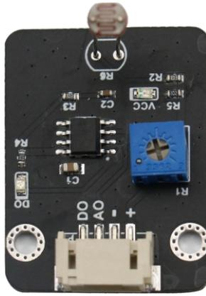
产品详情及参数：光敏电阻是一种光控可变电阻器。光敏电阻具有光电导性，可用于光敏探测器电路。光敏电阻是由高电阻半导体制成的。在黑暗中光敏电阻的电阻可以高达几兆欧（MΩ），而在充足光线下，光敏电阻的电阻可以低至几百欧姆。如果光敏电阻上的入射光超过一定的频率，光子被半导体吸收给束缚电子足够的能量跳跃进入传导带。由此产生的自由电子导电，从而降低电阻。
